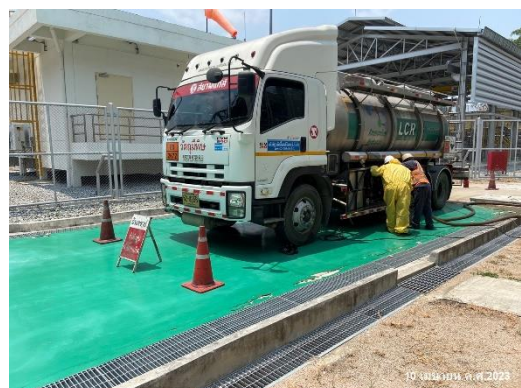
ภาพที่ 2.2-34 การวางกรวยกันรอบพื้นที่ขณะทำการขนถ่ายแอมโมเนียมไฮดรอกไซด์เหลว
