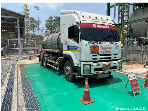
ภาพที่ 2.2-34 การวางกรวยกันรอบพื้นที่ขณะทำการขนถ่ายแอมโมเนียมไฮดรอกไซด์เหลว
